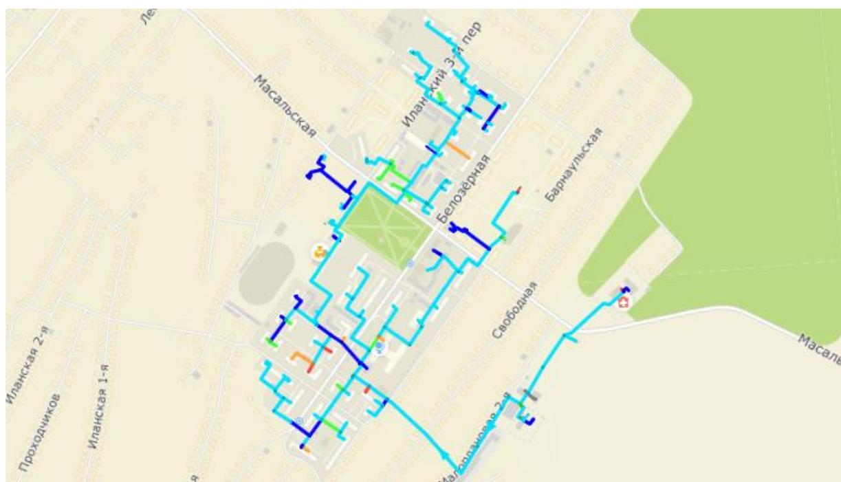
**Рисунок 3-36- Расчетная схема удельных потерь давления от Котельной №123 АО «Теплоэнерго» – закрытая система ГВС (2022 г.)**
