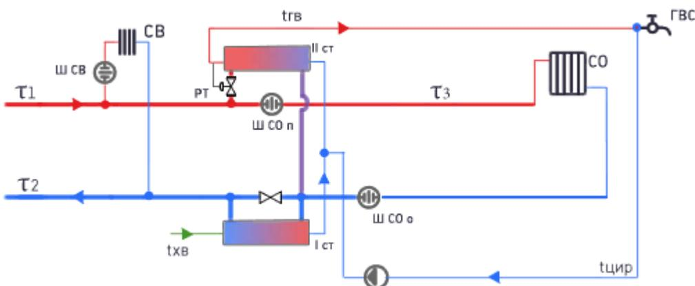
**Рисунок 2-6 – Потребитель с двухступенчатым смешанным подключением подогревателей ГВС и непосредственным присоединением СО (схема № 32)**
