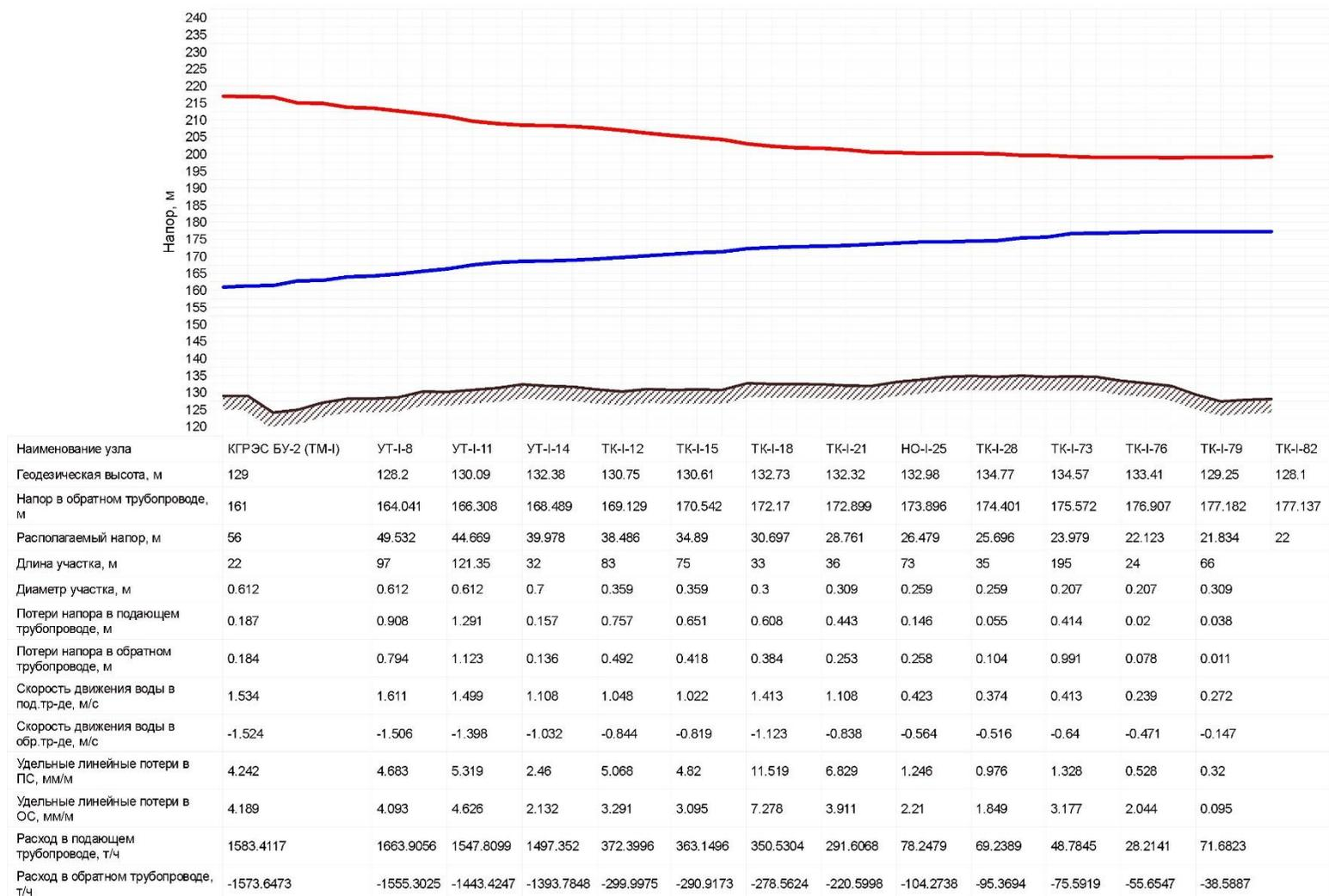
Рисунок 3-10 – Пьезометрический график от КГРЭС БУ-2 (ТМ-I) до «ТК-I-82» – закрытая система ГВС (2022 г.)
