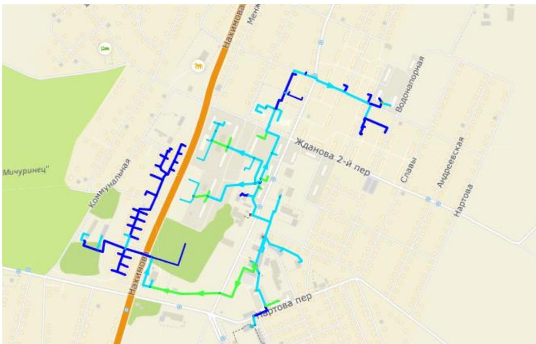
Рисунок 3-22 – Расчетная схема удельных потерь давления от котельной №35 АО «Теплоэнерго» в режиме закрытого водоразбора на ГВС (2022 г.)
