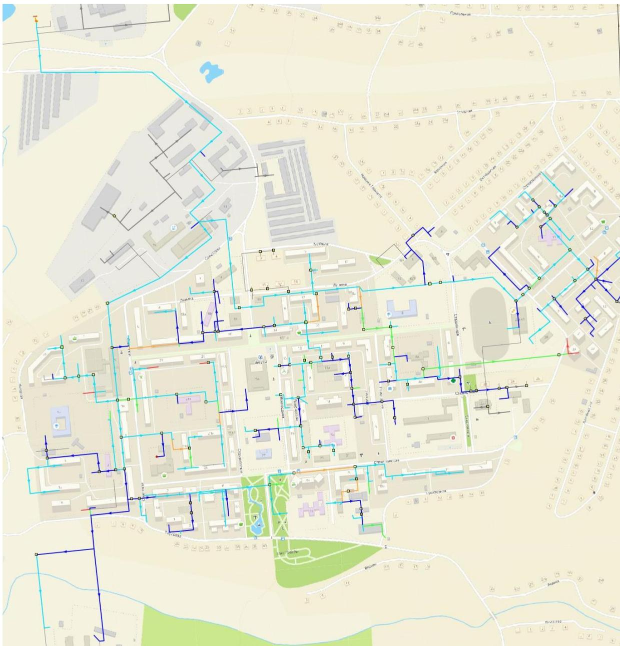
**Рисунок 3-39 – Расчетная схема удельных потерь давления от котельной №8 ОАО «СКЭК» - открытая система ГВС (2020 г.)**
