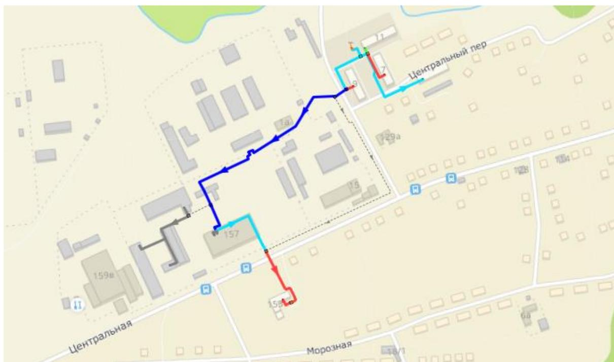
Рисунок 3-28 – Расчетная схема удельных потерь давления от котельной №97 АО «Теплоэнерго» – закрытая схема ГВС (2022 г.)
