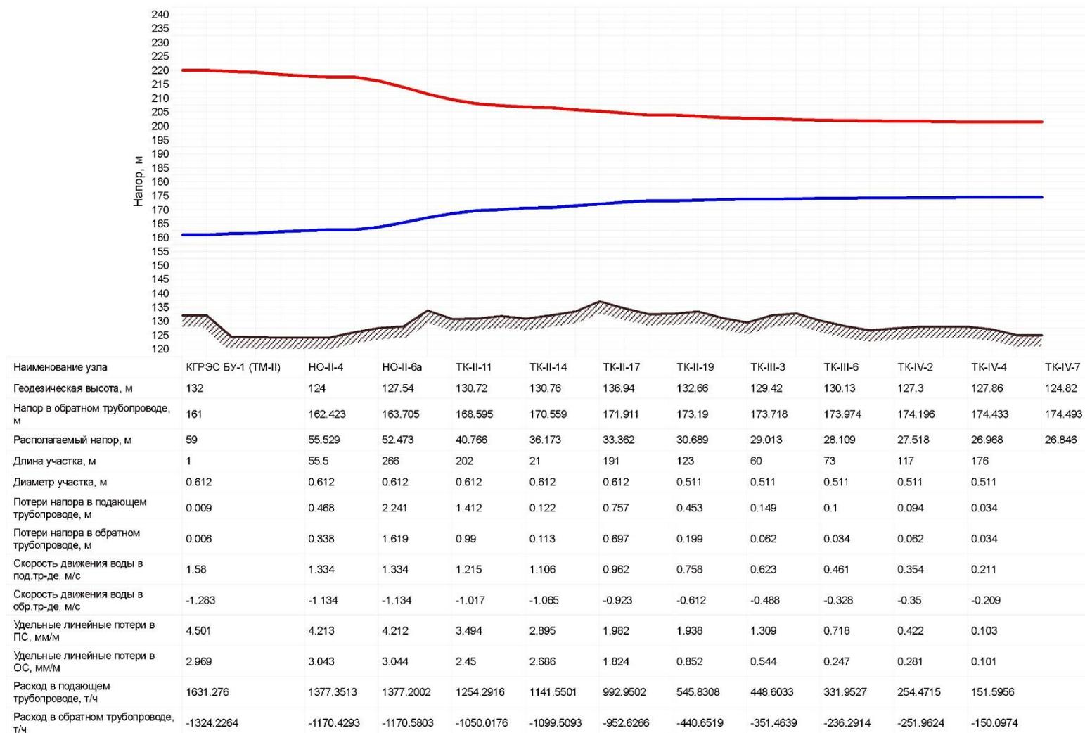
Рисунок 3-8 – Пьезометрический график от КГРЭС БУ-1 (ТМ-II) до «ТК-IV-7» – закрытая система ГВС (2022 г.)
