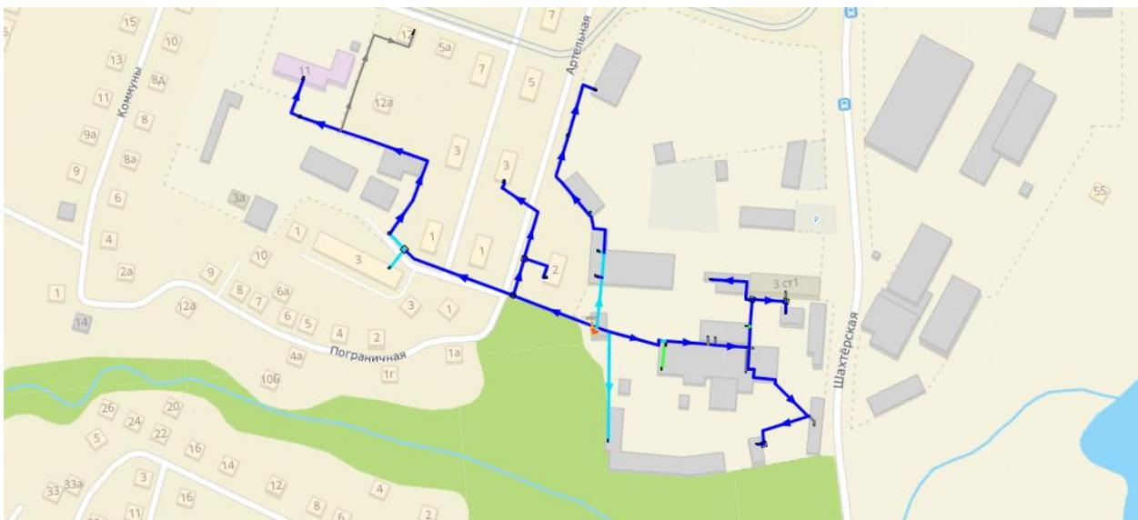
Рисунок 3-29 – Расчетная схема удельных потерь давления от котельной №101 АО «Теплоэнерго» – открытая схема ГВС (2020 г.)
