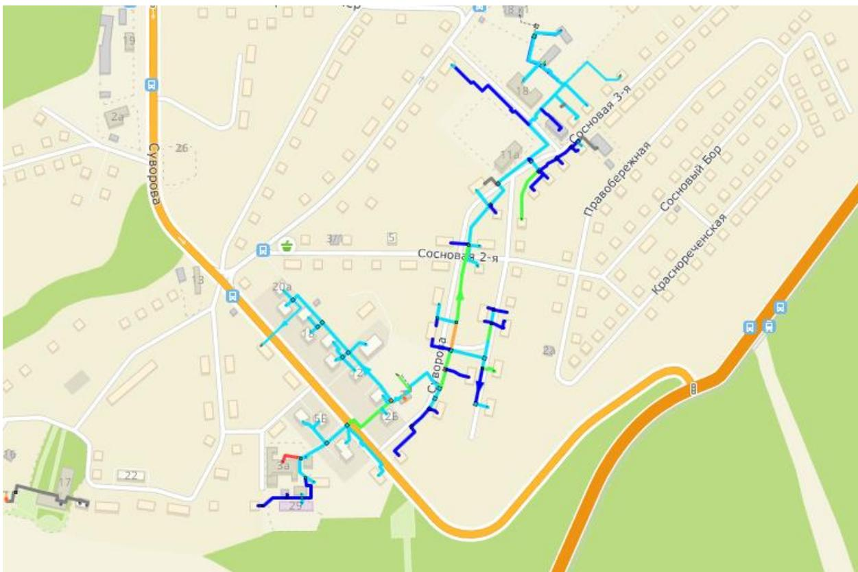
**Рисунок 3-33 – Расчетная схема удельных потерь давления от котельной №118 АО «Теплоэнерго» – открытая система ГВС (2020 г.)**
