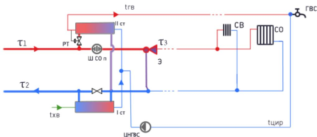
Рисунок 2-9 – ЦТП с двухступенчатым смешанным подключением подогревателей ГВС и элеваторным смешением на СО (схема №10)
