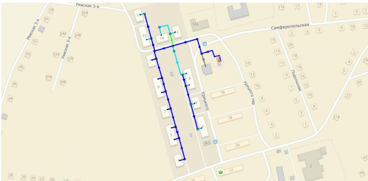
**Рисунок 3-23 – Расчетная схема удельных потерь давления от котельной №92 АО «Теплоэнерго» в режиме открытого водоразбора (2020 г.)**
