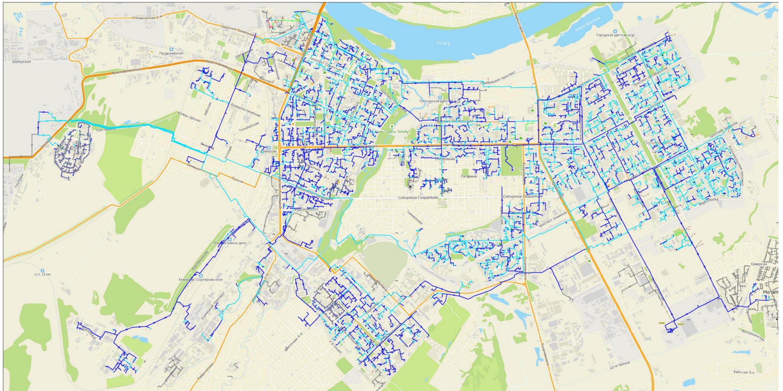
**Рисунок 3-4 – Расчетная схема удельных потерь давления от Кемеровской ГРЭС и Ново-Кемеровской ТЭЦ в режиме открытого водоразбора на 2020 г.**
