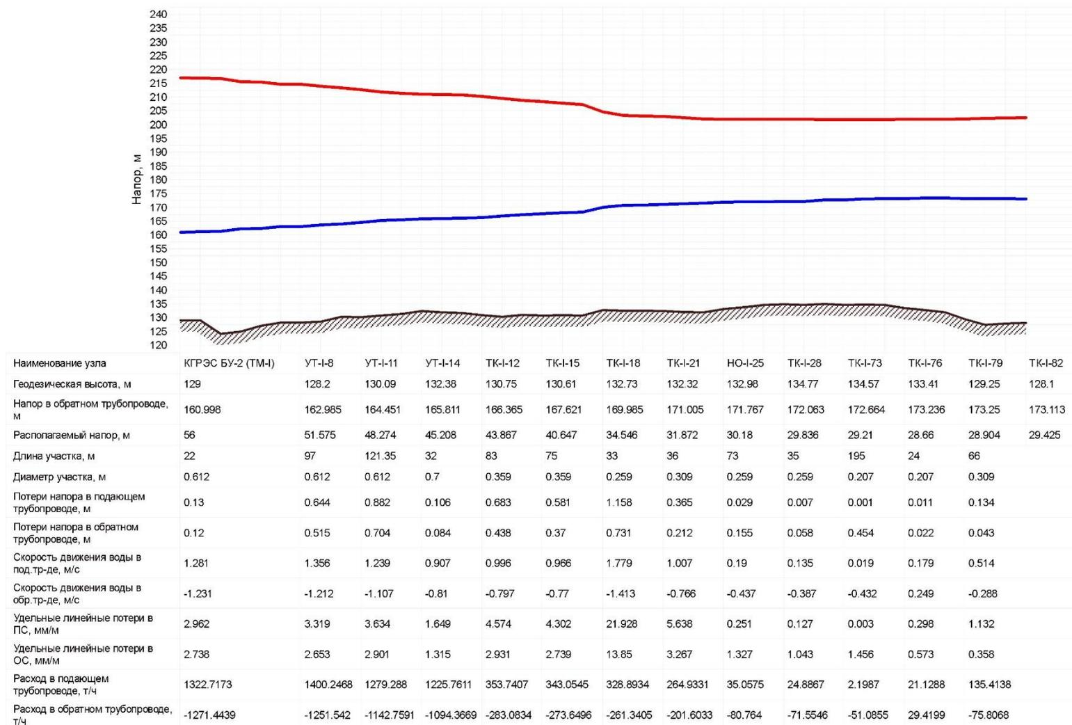
Рисунок 3-9 – Пьезометрический график от КГРЭС БУ-2 (ТМ-I) до «ТК-I-82» – открытая система ГВС (2020 г.)
