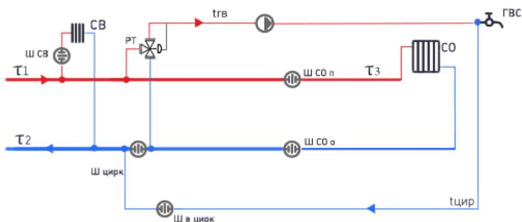
Рисунок 2-2 – Потребитель с непосредственным присоединением СО (схема № 4)
