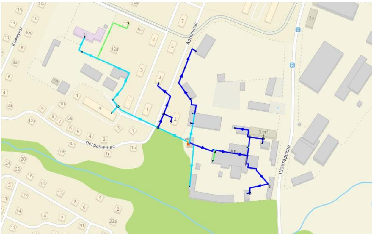
Рисунок 3-30 – Расчетная схема удельных потерь давления от котельной №101 АО «Теплоэнерго» – закрытая схема ГВС (2022 г.)
