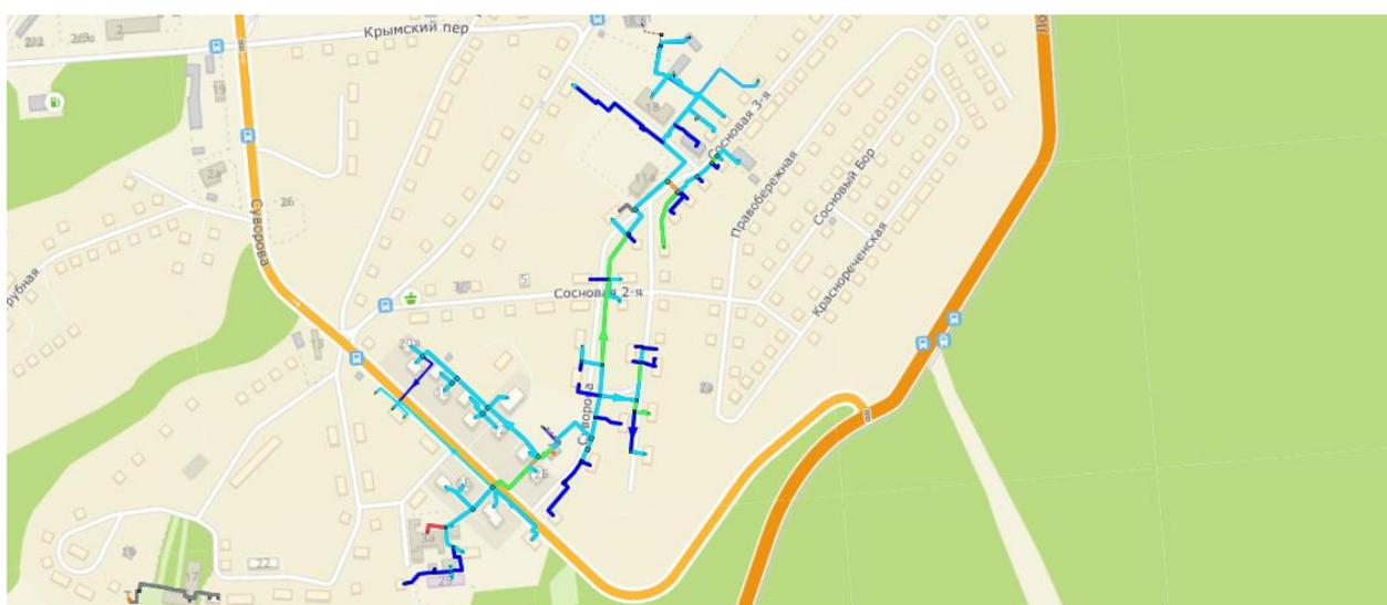
**Рисунок 3-34 – Расчетная схема удельных потерь давления от котельной №118 АО «Теплоэнерго» – закрытая система ГВС, после осуществления мероприятий (2022 г.)**
