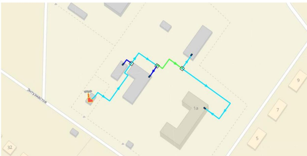
**Рисунок 3-38 – Расчетная схема удельных потерь давления от котельной №163 АО «Теплоэнерго» - закрытая система ГВС (2022 г.)**
