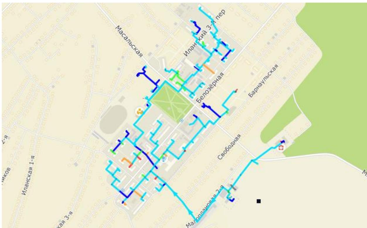
**Рисунок 3-35 – Расчетная схема удельных потерь давления от котельной №123 АО «Теплоэнерго» – открытая система ГВС (2020 г.)**
