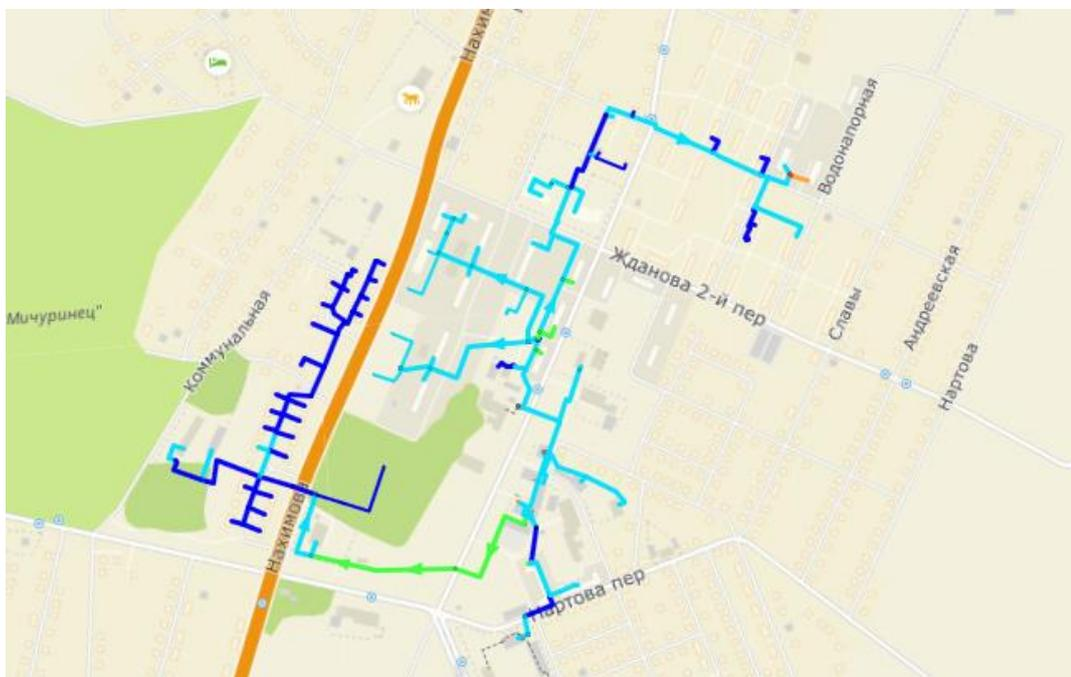
Рисунок 3-21 – Расчетная схема удельных потерь давления от котельной №35 АО «Теплоэнерго» в режиме открытого водоразбора на ГВС (2020 г.)
