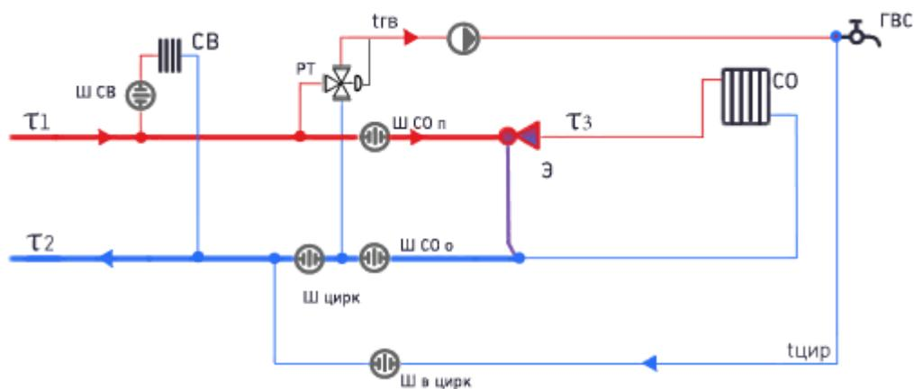
Рисунок 2-1 – Потребитель с элеваторным присоединением СО (схема № 6)
