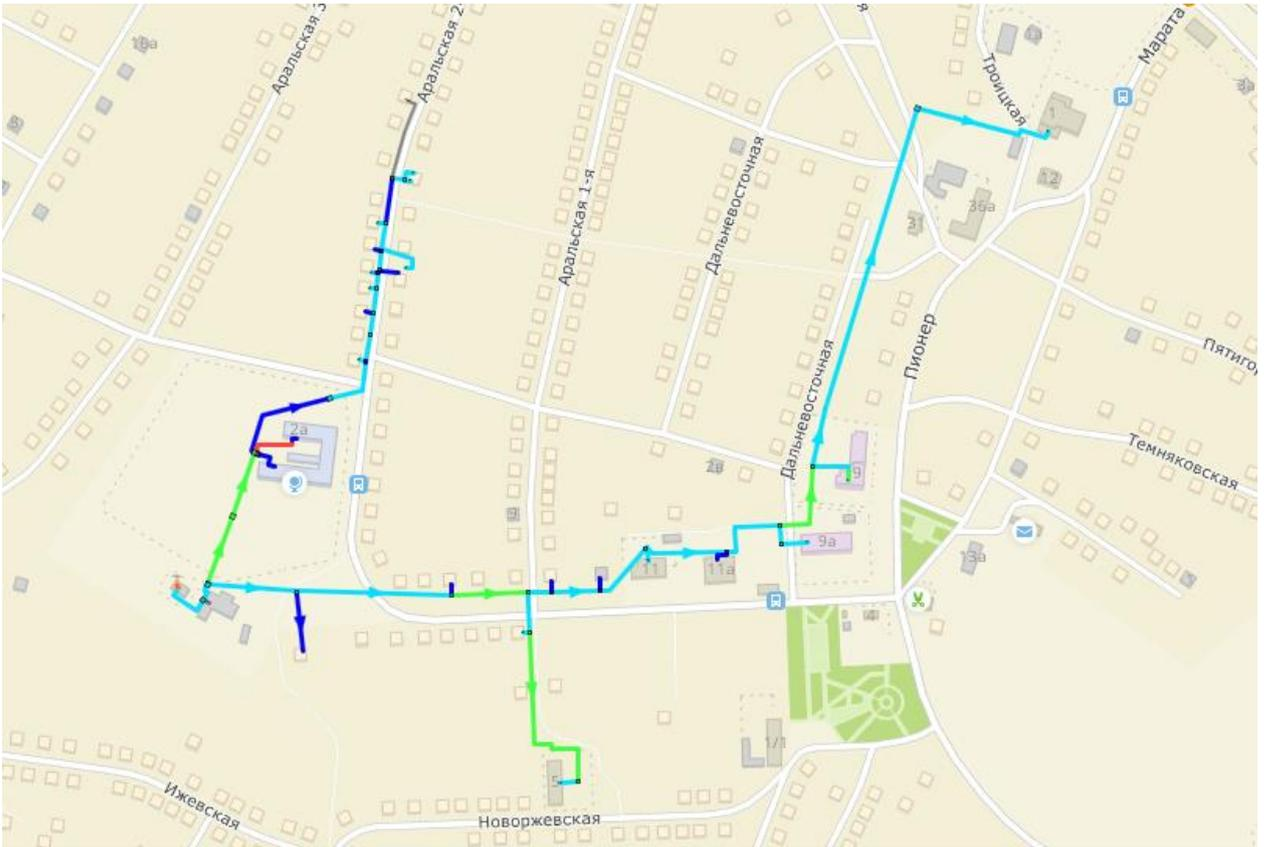
**Рисунок 3-25 – Расчетная схема удельных потерь давления от котельной №96 АО «Теплоэнерго» – открытая система ГВС (2020 г.)**
