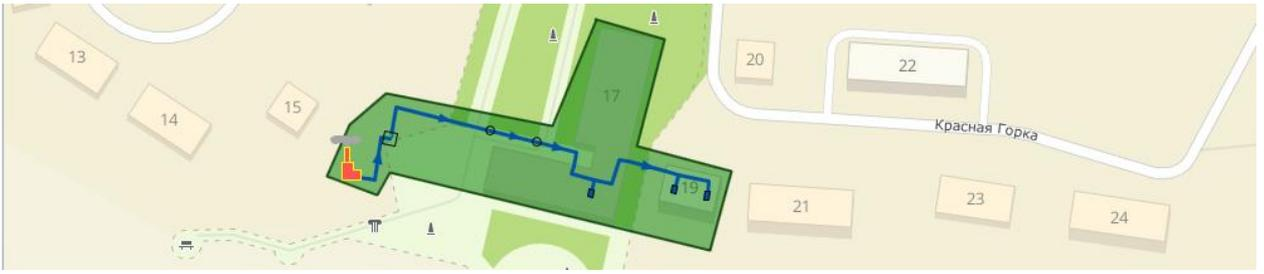
**Рисунок 4-81 – Зоны надежного и ненадежного теплоснабжения от котельной № 110**
