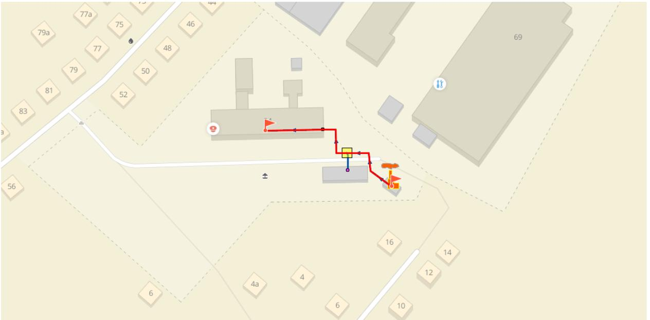
**Рисунок 4-40 – Путь от котельной № 42 до потребителя с минимальными показателями вероятности безотказной работы**
