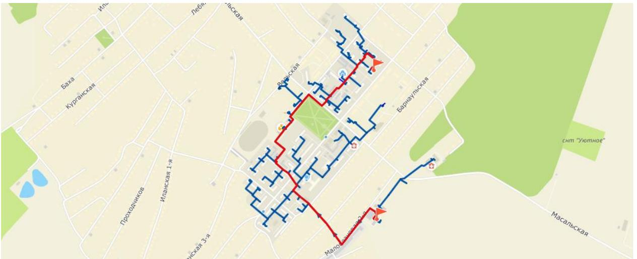
**Рисунок 4-94 – Путь от котельной № 123 до потребителя с минимальными показателями вероятности безотказной работы**
