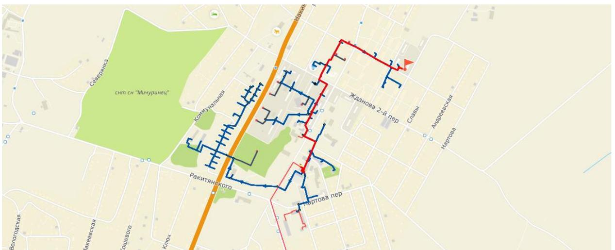
**Рисунок 4-34 – Путь от котельной № 35 до потребителя с минимальными показателями вероятности безотказной работы**
