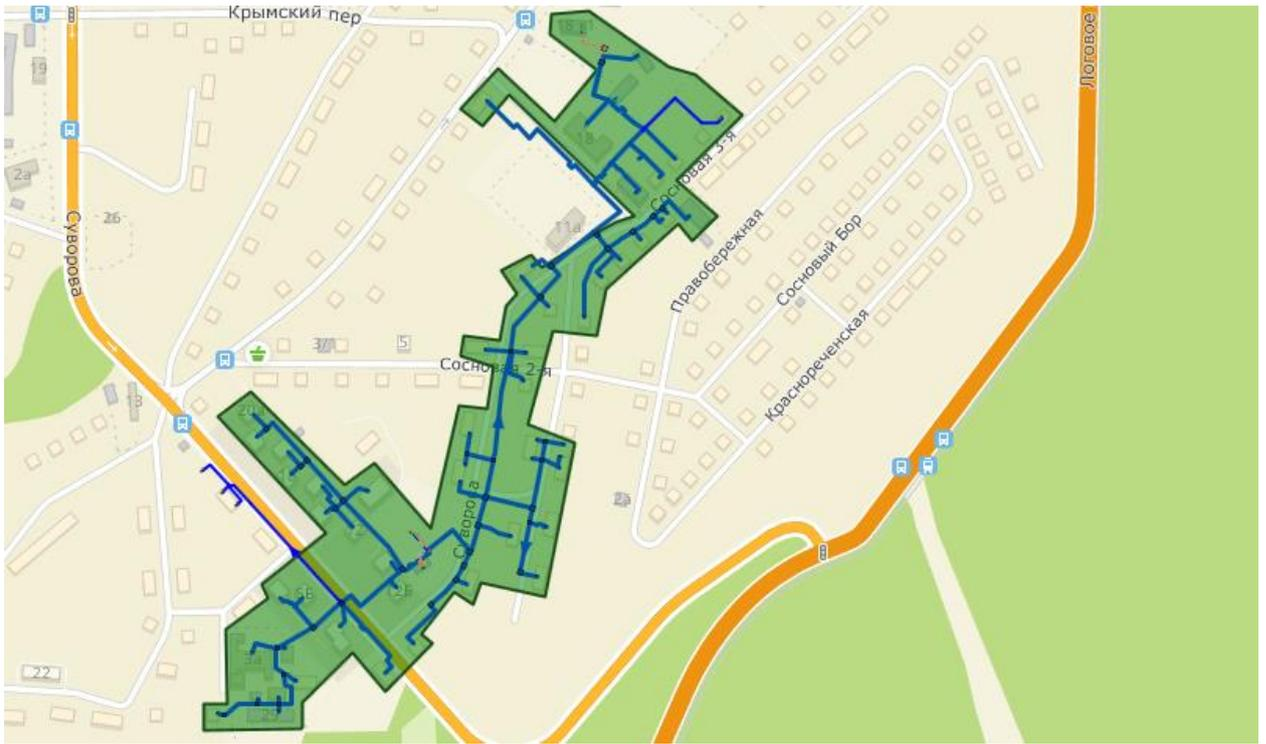
**Рисунок 4-90 – Зоны надежного и ненадежного теплоснабжения от котельной № 118**
