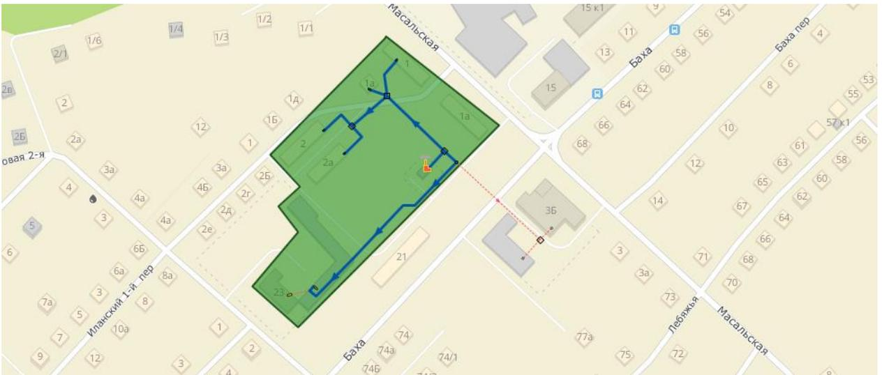
**Рисунок 4-93 – Зоны надежного и ненадежного теплоснабжения от котельной № 122**
