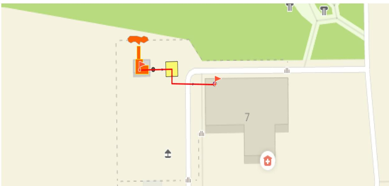
**Рисунок 4-10 – Путь от котельной № 4 до потребителя с минимальными показателями вероятности безотказной работы**
