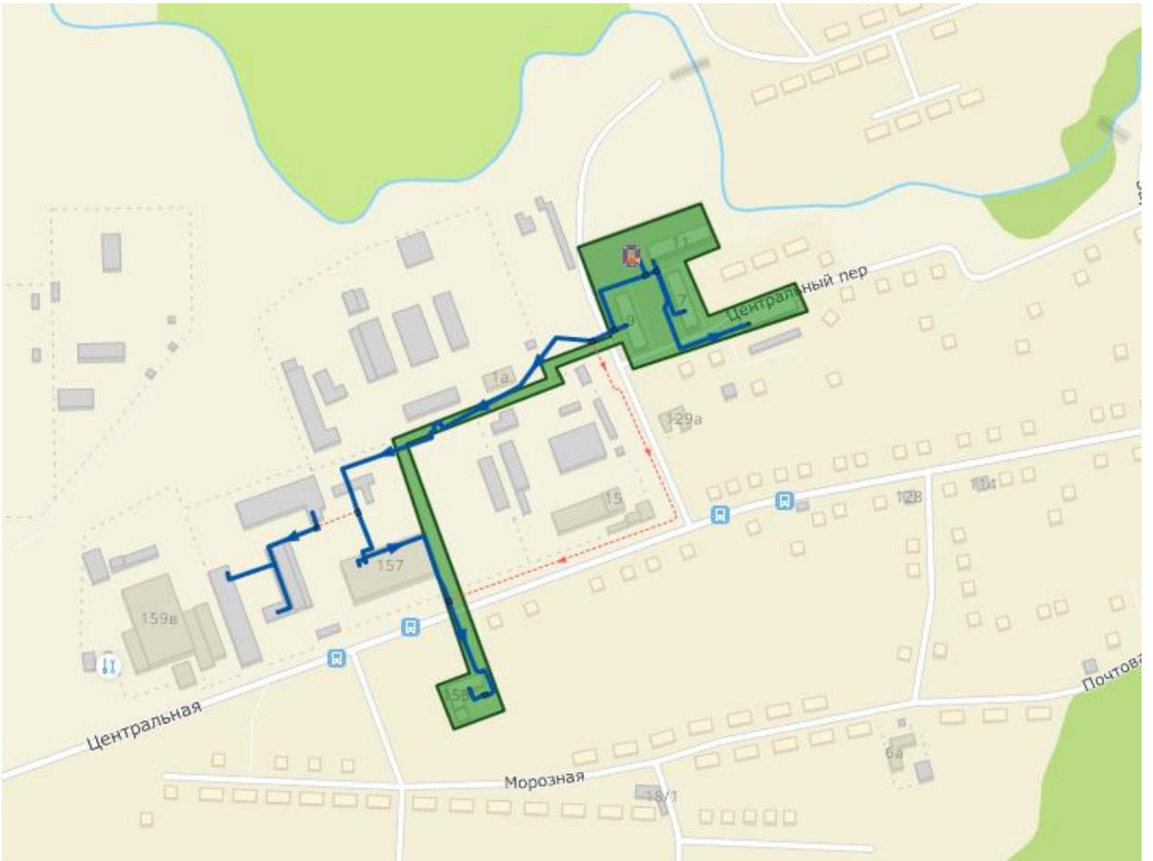
**Рисунок 4-69 – Зоны надежного и ненадежного теплоснабжения от котельной № 97**
