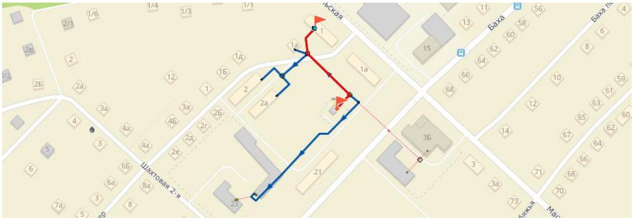
**Рисунок 4-91 – Путь от котельной № 122 до потребителя с минимальными показателями вероятности безотказной работы**
