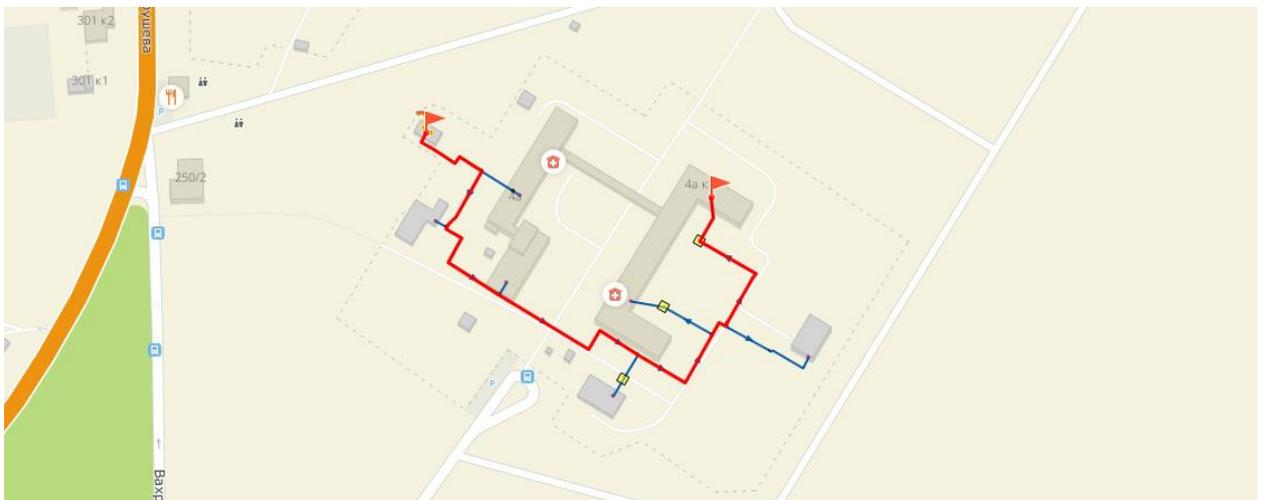
**Рисунок 4-28 – Путь от котельной № 31 до потребителя с минимальными показателями вероятности безотказной работы**
