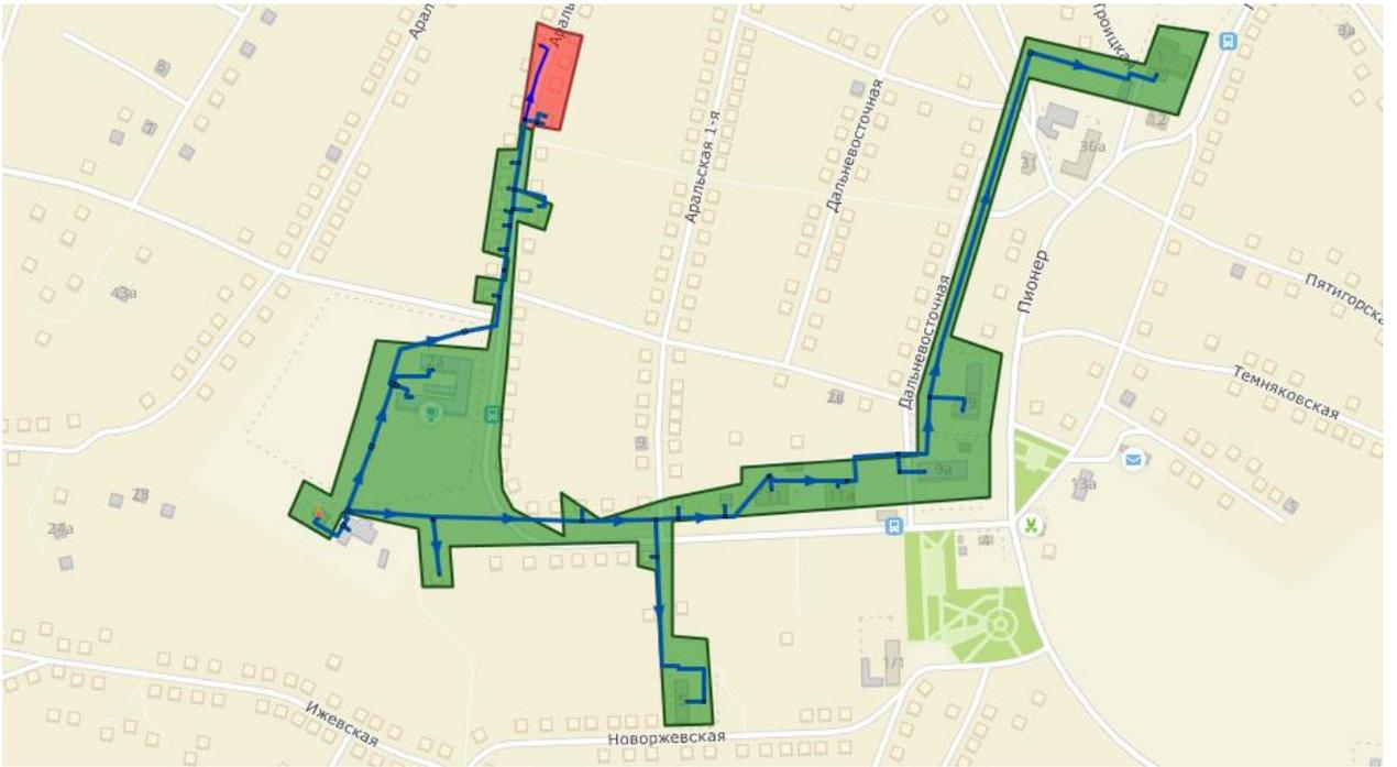
**Рисунок 4-66 – Зоны надежного и ненадежного теплоснабжения от котельной № 96**
