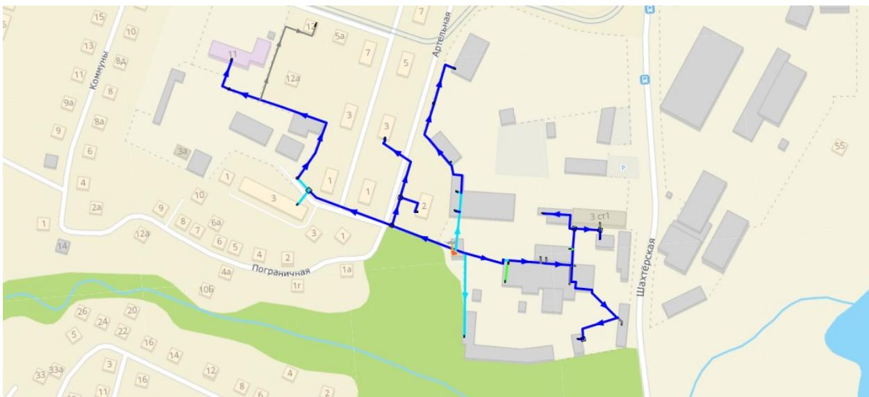
Рисунок 3-37 – Расчетная схема удельных потерь давления от котельной №101 АО «Теплоэнерго» – открытая схема ГВС (2020 г.)
