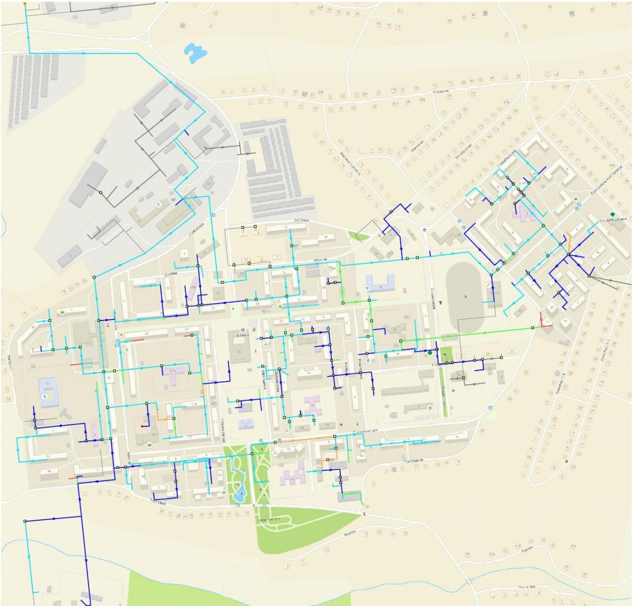
**Рисунок 3-48 – Расчетная схема удельных потерь давления от котельной №8 ООО «СКЭЖ» - закрытая система ГВС после выполнения мероприятий (2022 г.)**
