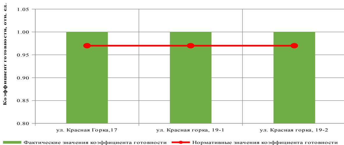
**Рисунок 5-128 – Коэффициент готовности системы к теплоснабжению потребителей в зоне действия котельной №110 (путь – рисунок 4-80)**
