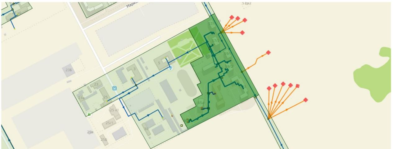
**Рисунок 4-87 – Зоны надежного и ненадежного теплоснабжения от котельной № 114**
