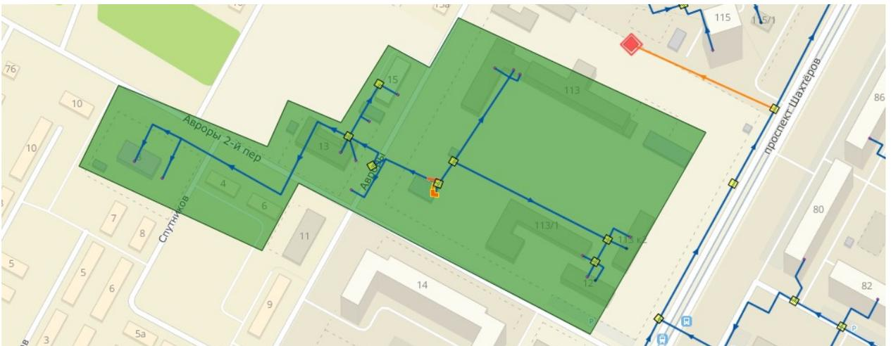
**Рисунок 4-39 – Зоны надежного и ненадежного теплоснабжения от котельной № 38**
