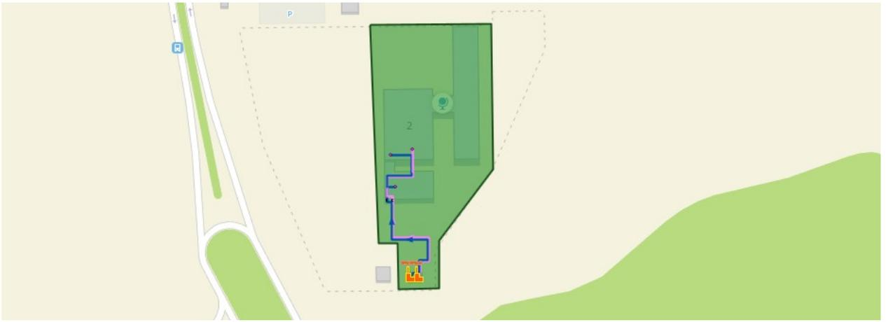
**Рисунок 4-15 – Зоны надежного и ненадежного теплоснабжения от котельной № 6**
