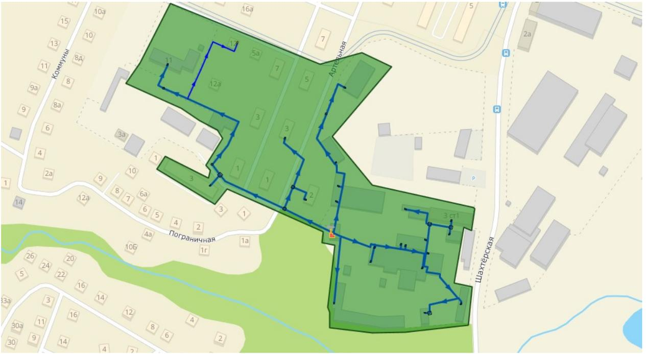
**Рисунок 4-72 – Зоны надежного и ненадежного теплоснабжения от котельной № 101**
