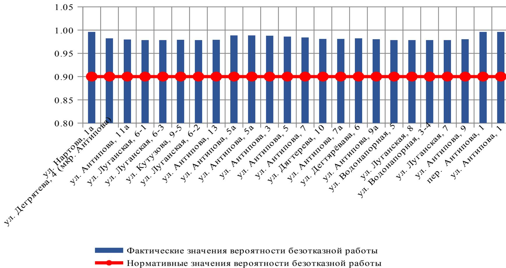
Рисунок 4-36 – Вероятность безотказного теплоснабжения потребителей в зоне теплоснабжения котельной №35
