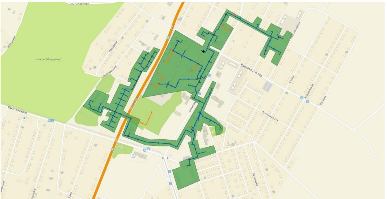
**Рисунок 4-35 – Зоны надежного и ненадежного теплоснабжения от котельной № 35**
