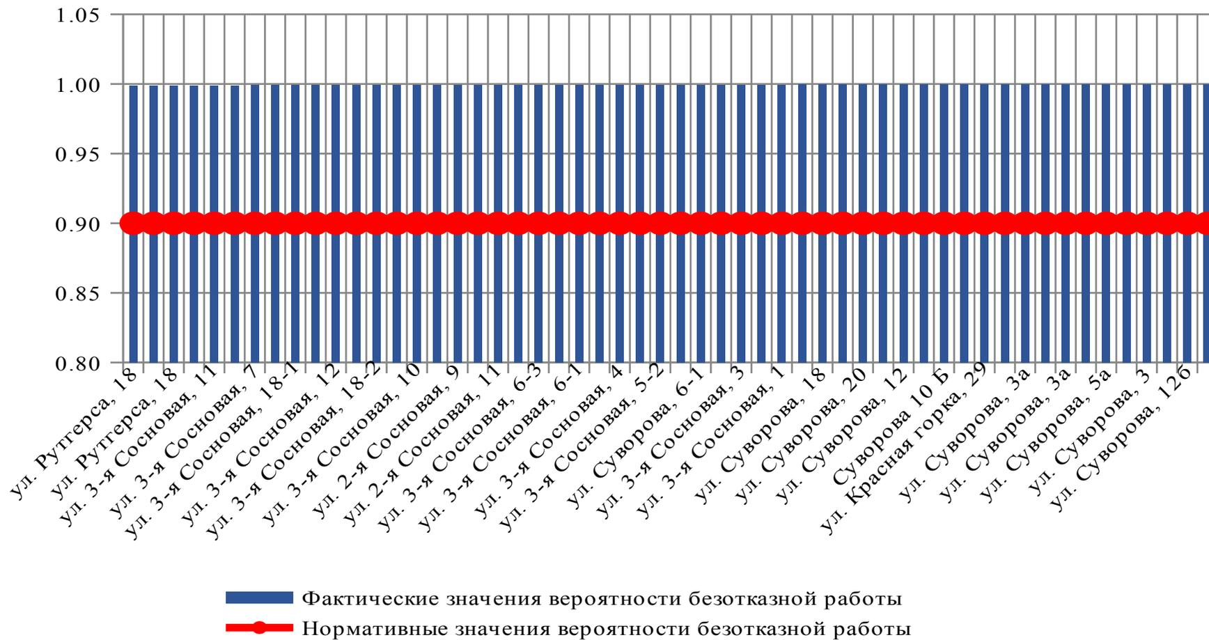
Рисунок 4-89 – Вероятность безотказного теплоснабжения потребителей в зоне теплоснабжения котельной №118
