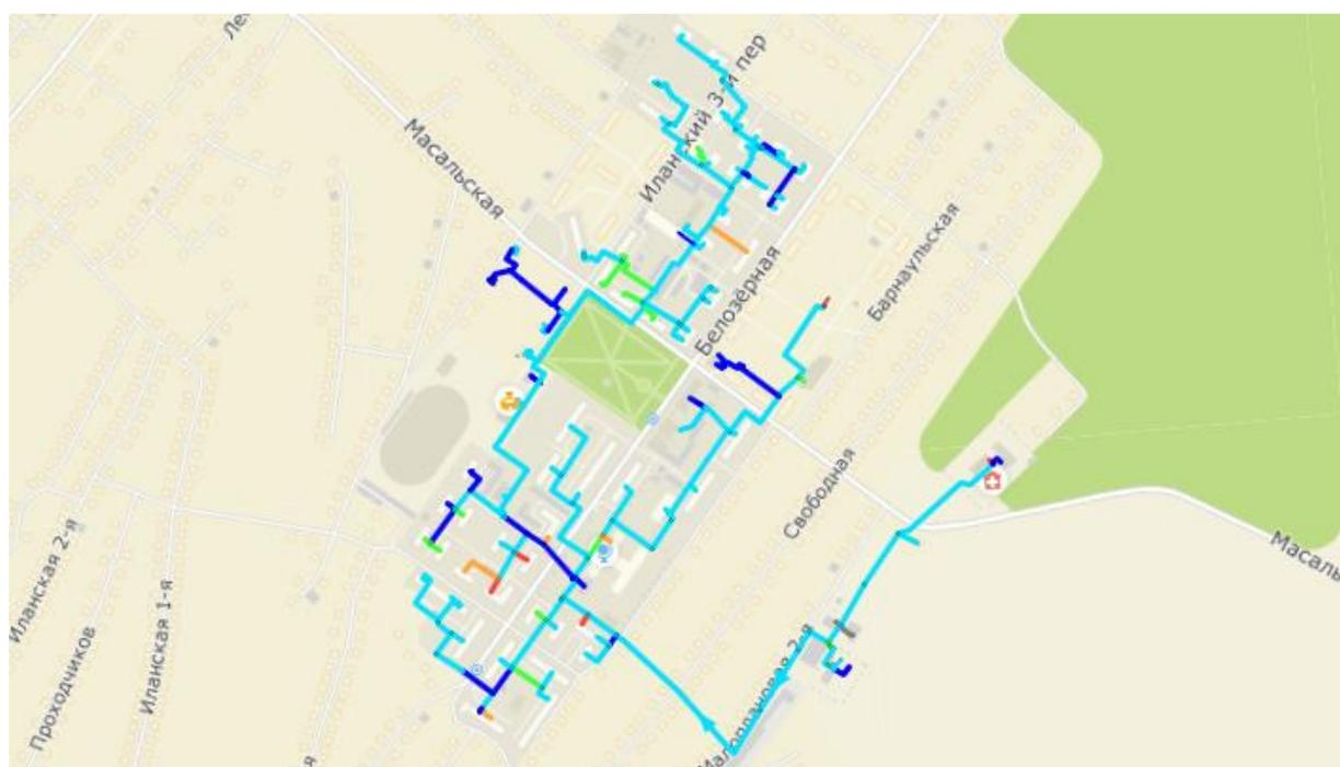
Рисунок 3-47- Расчетная схема удельных потерь давления от Котельной №123 АО «Теплоэнерго» – закрытая система ГВС
