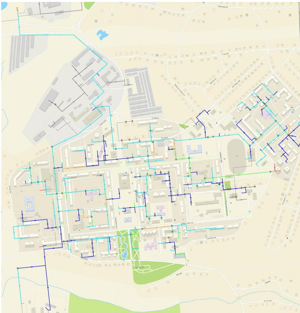
**Рисунок 3-50 – Расчетная схема удельных потерь давления от Котельной №8 ООО «СКЭК» - открытая система ГВС**
