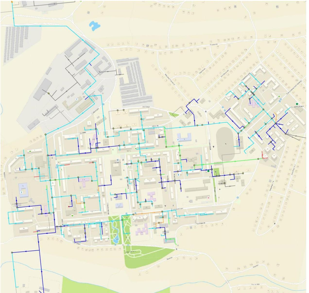
**Рисунок 3-51 – Расчетная схема удельных потерь давления от котельной №8 ООО «СКЭЖ» - закрытая система ГВС после выполнения мероприятий Котельная № 9 ОАО «СКЭЖ»**
