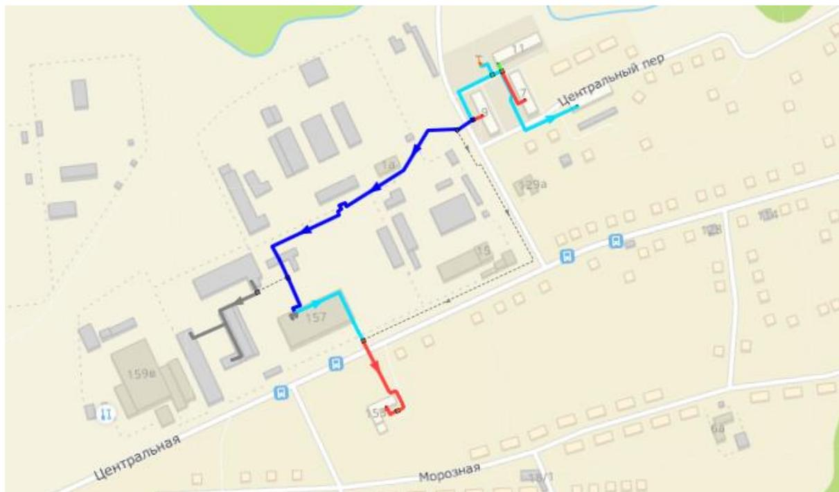
Рисунок 3-39 – Расчетная схема удельных потерь давления от котельной №97 АО «Теплоэнерго» - закрытая схема ГВС
