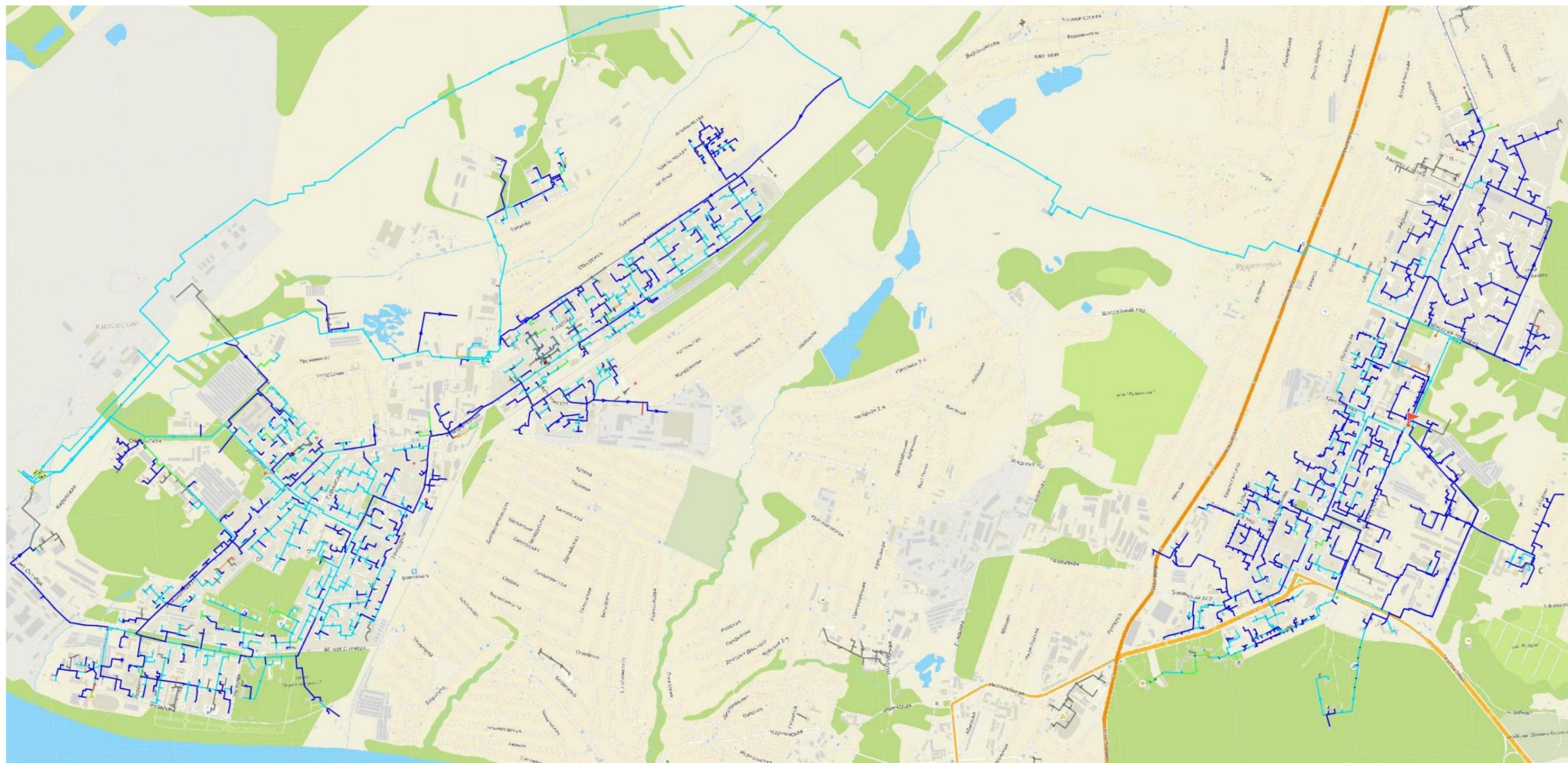
**Рисунок 3-6 – Расчетная схема удельных потерь давления от Кемеровской ТЭЦ в режиме закрытого водоразбора после осуществления мероприятий**
