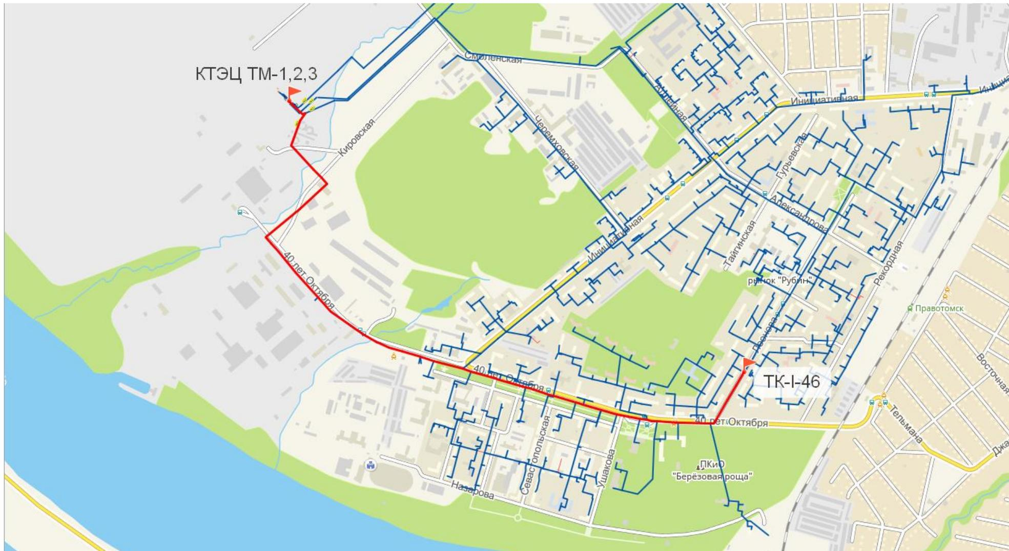
Рисунок 3-19 - Путь для построения пьезометрического графика участка от КТЭЦ ТМ-1.2.3 до ТК-I-46
