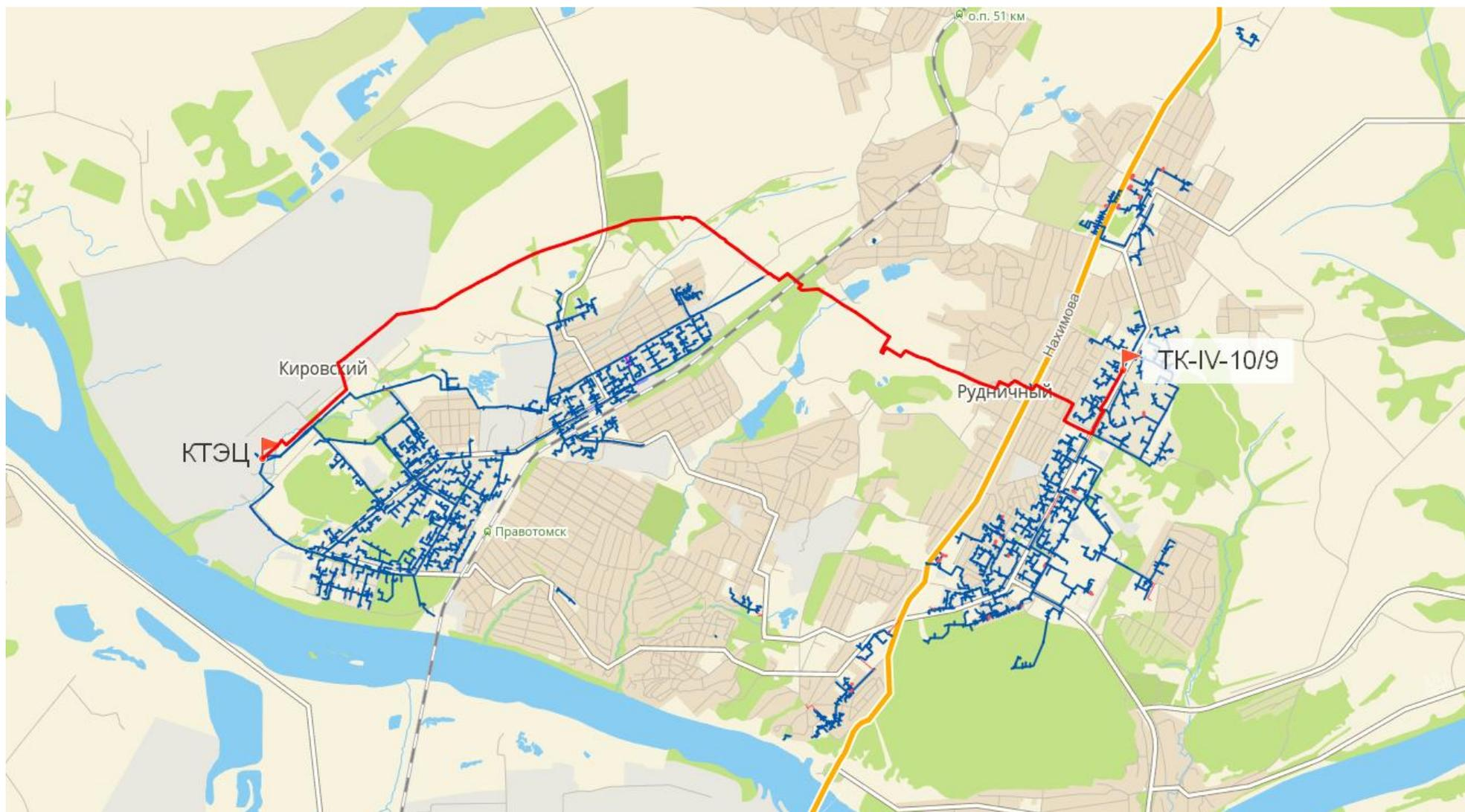
**Рисунок 3-27 – Путь для построения пьезометрического графика участка от КТЭЦ ТМ-4 до ТК-IV-10/9**
