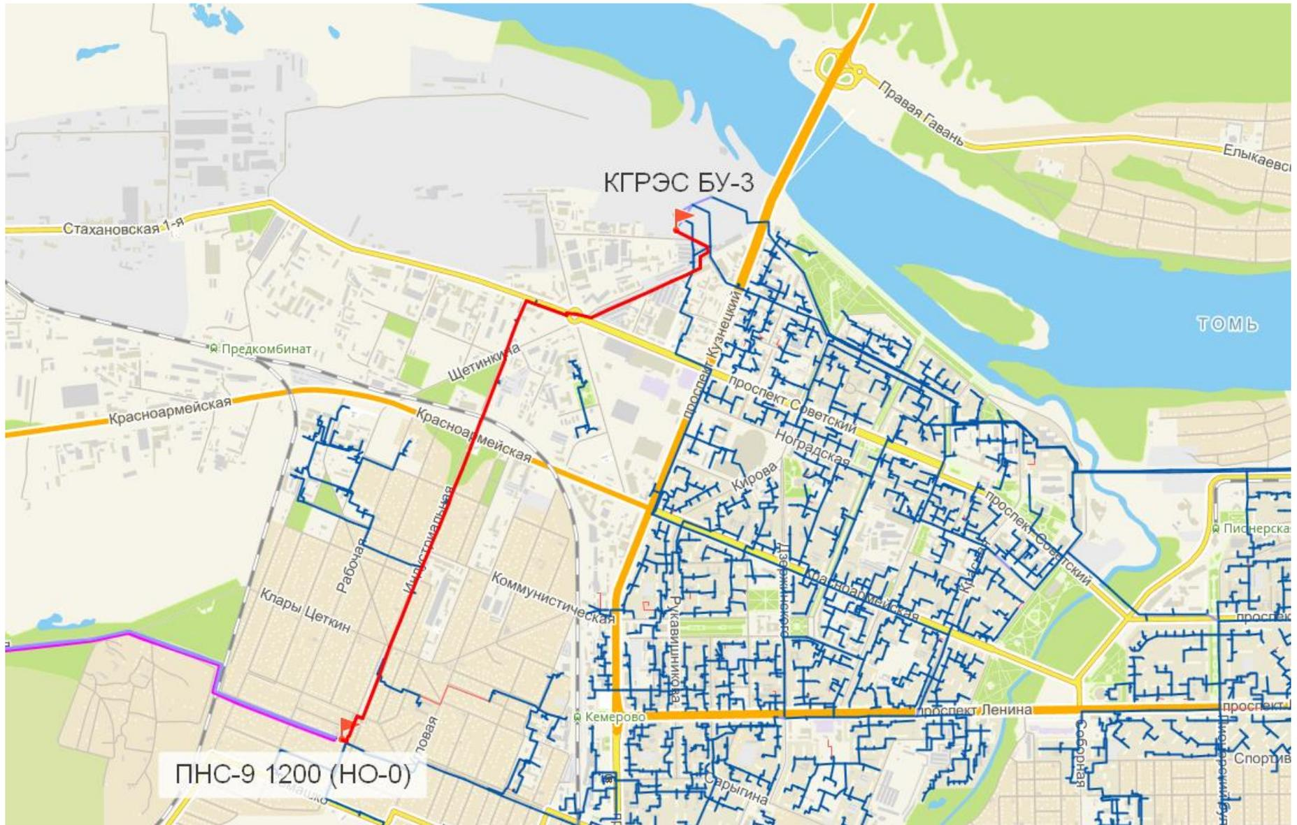
Рисунок 3-9 - Путь для построения пьезометрического графика участка от КГРЭС БУ-3 (ТМ-Ш) до ПНС-9 1200 (НО-0)
