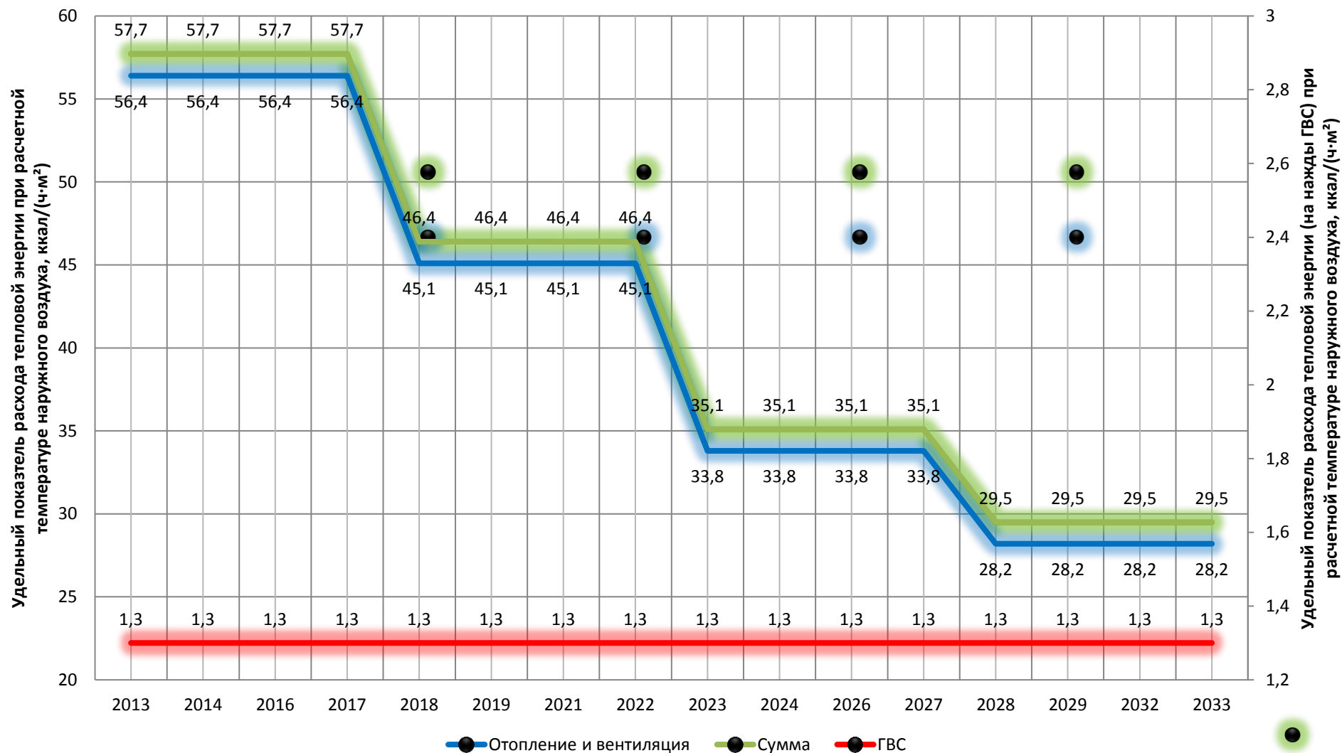
Рисунок 4-3 – Изменение нормируемого удельного расхода тепловой энергии на отопление, вентиляцию и ГВС на примере 1-этажного здания сервисного обслуживания
