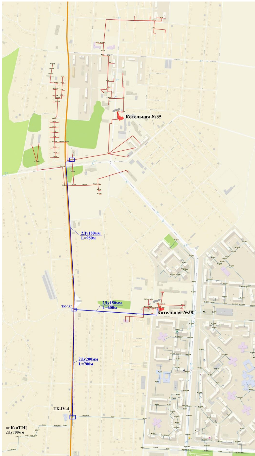
Рисунок 11-2 – Схема переключения потребителей котельных №№ 35 и 38 АО «Теплоэнерго» на теплоснабжение от Кемеровской ТЭЦ
