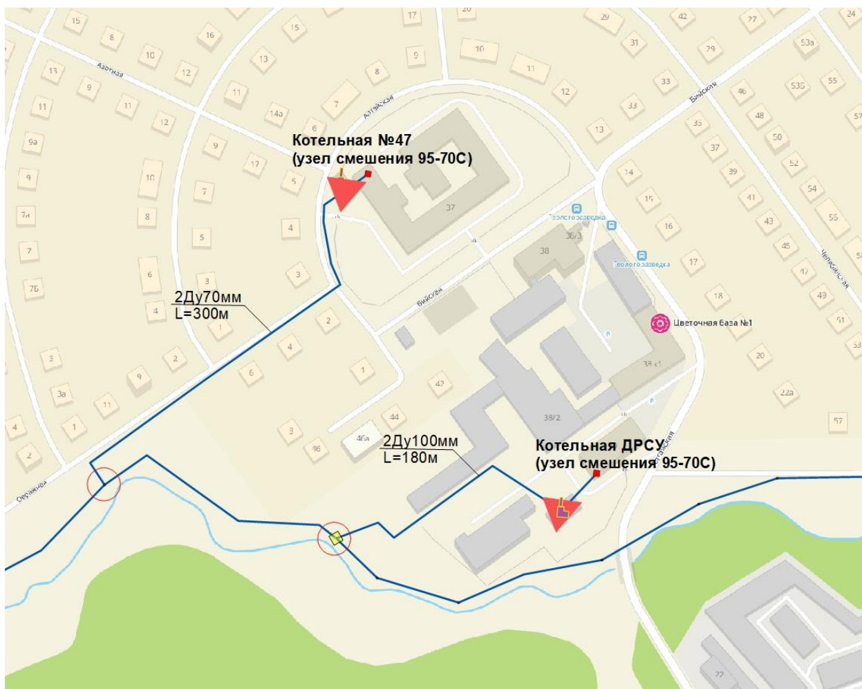
Рисунок 11-3 – Схема переключения потребителей котельной № 47 АО «Теплоэнерго» и котельной АО «Кемеровское ДРСУ» на теплоснабжение от Ново-Кемеровской ТЭЦ
