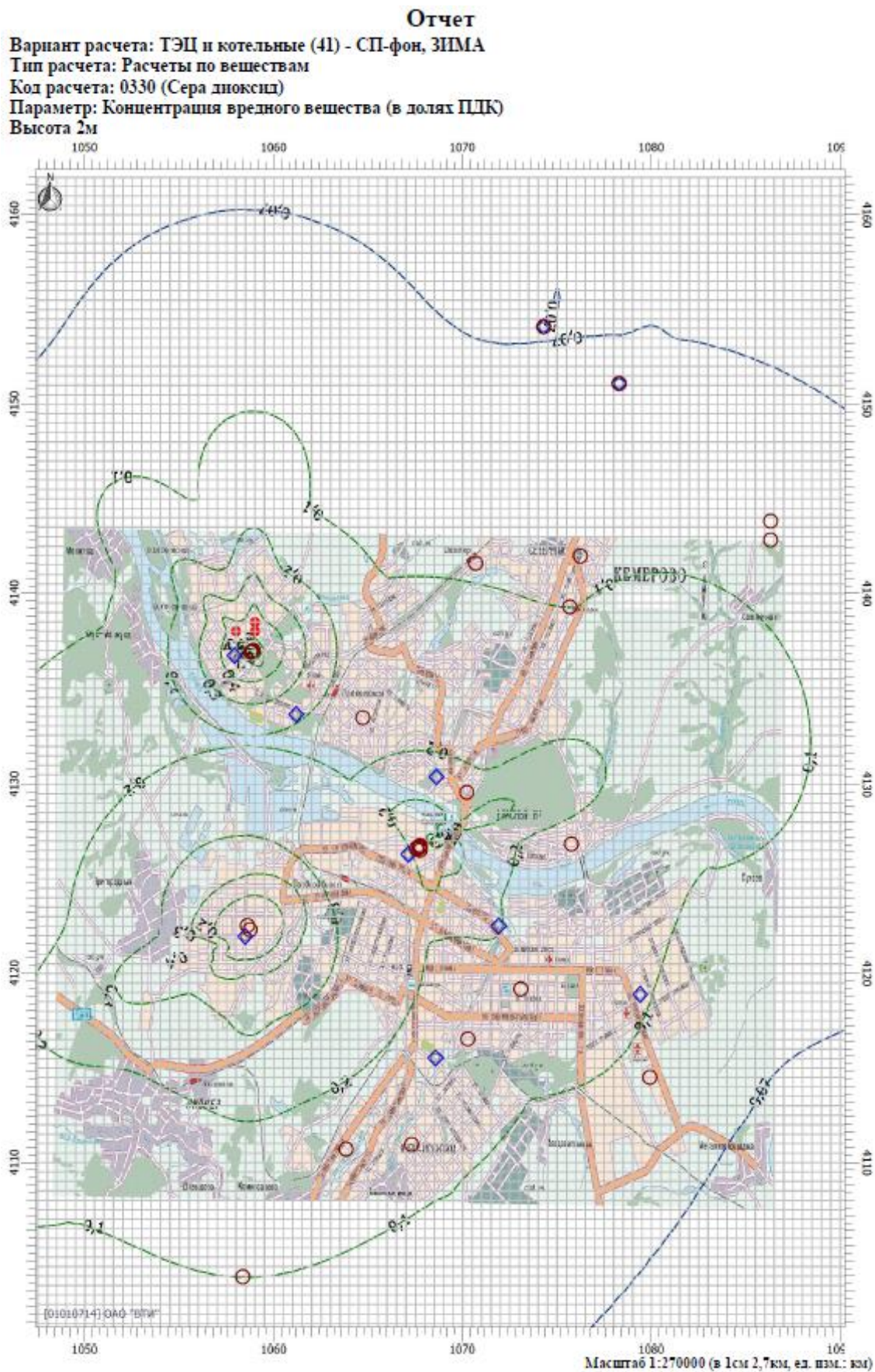
Рисунок 2.8.1 – Поля максимальных приземных концентраций от выбросов диоксида серы на существующее положение (зимний период с учетом фона) Условные обозначения: ○ – ИЗАВ рассматриваемых теплоисточников, ◇ – ПНЗ и заданные точки по фону
