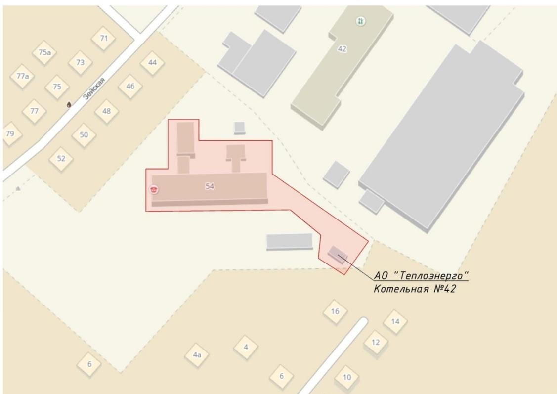
**Рисунок 4.2-12 –Зона действия котельной № 42**
