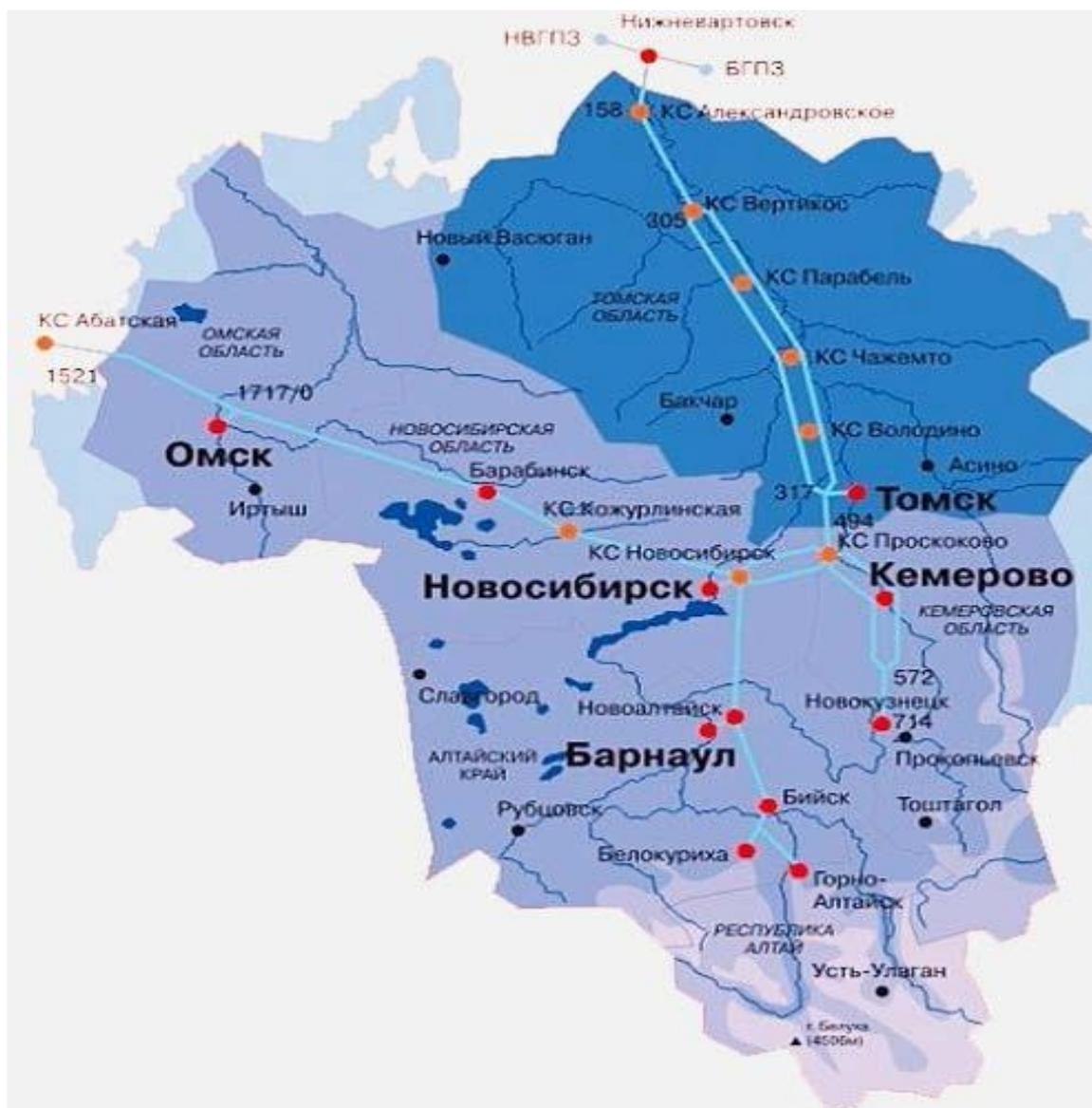
Рисунок 8-1 – Схема газоснабжения г. Кемерово
