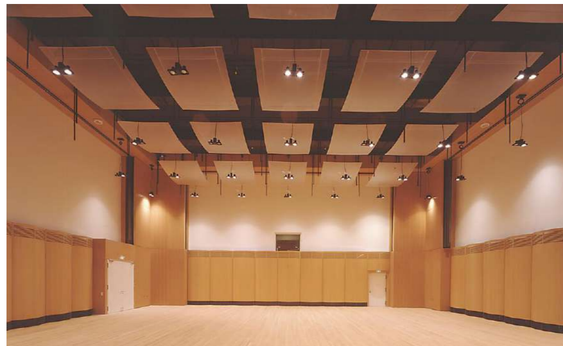
Рис. 3.: репетиционный зал оркестра расположен рядом с нижней сценой и ниже кармана сцены. Чтобы соответствовать высоким акустическим стандартам, этот зал требует так называемой конструкции коробка в коробке. Ссылка на другой объект: Репетиционный зал оркестра Баварской государственной оперы, Мюнхен. Слева: во время строительства коробки в коробке: справа: готовый зал
